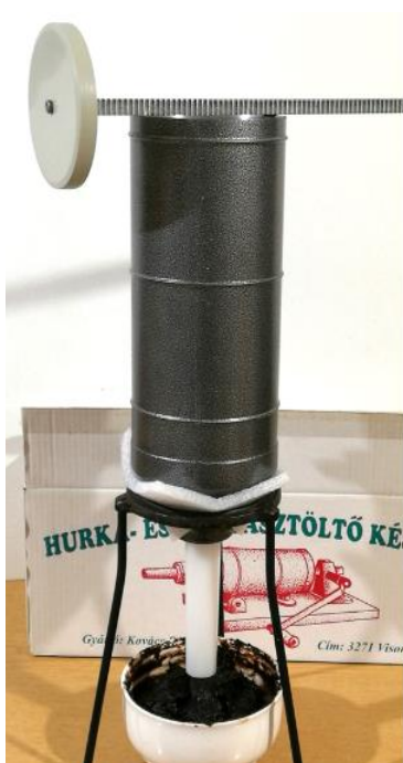
4. ábra: A szilvalekvár lecsorgásának mérése a függőleges helyzetű hurkatöltőben történt, amelyet kvázi tölcserként használtunk. A dugattyúra ható plusz F nyomóerő a ráhelyezett súlyzó súlyából eredt
