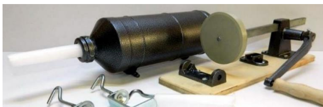
3. ábra: A szilvalekvár kifolyásának mérésére használt hurkatöltő mint „tölcsér”, amit függőlegesen fordítottunk (ld. 4. ábra)
